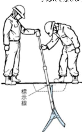
⑩ 打込み筒をそのままの状態にして案内板が樹木の方向に倒れるよう軽く叩き、支線の角度に合わせます。
