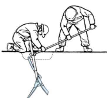
⑪ 打込み筒を抜いて支線ロッドを取り付けます。穴を埋戻して作業は終ります。
