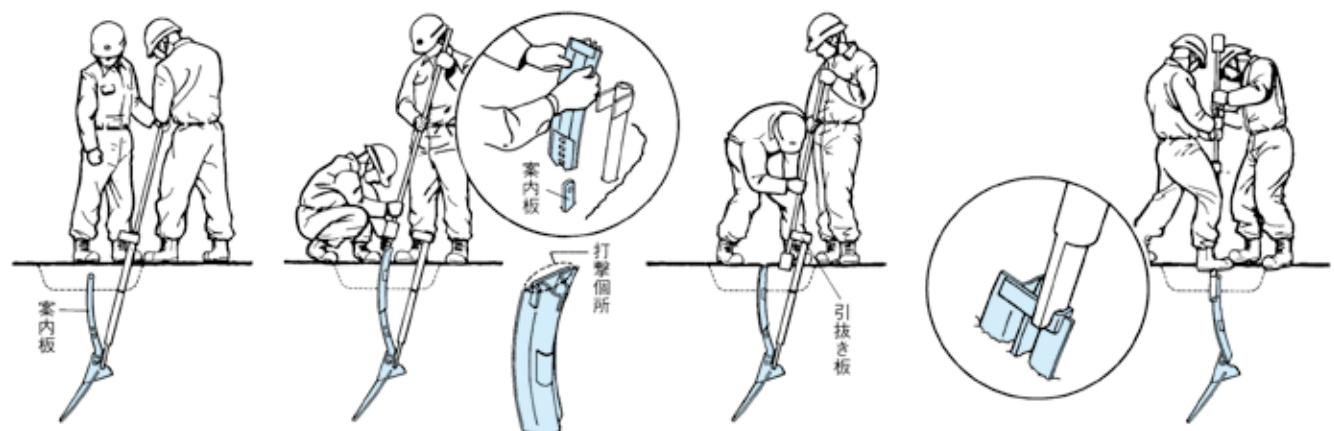
⑨ 打込み筒に刻まれた標示線が案内板の上端に一致したところで安定板の打込みは終わります。
